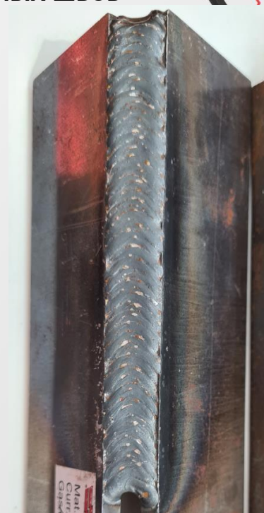
Проволока: Св-08Г2С-О, Ø1,0 мм Ток сварки: 85А Перекрытие зазора + заполнение Положение сварки: нижнее
