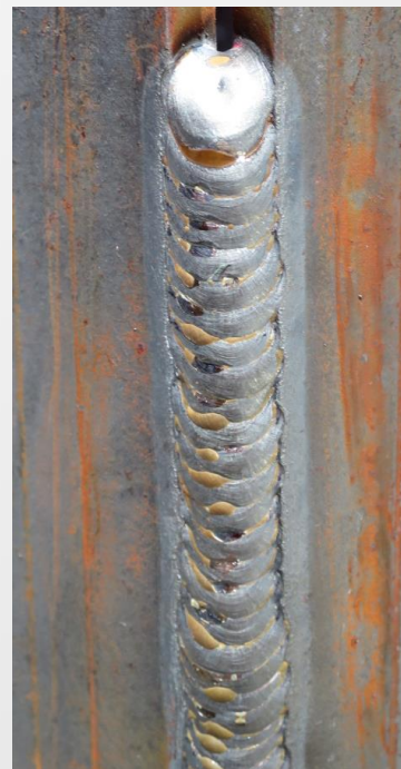
Проволока: Св-08Г2С-О Сварочный ток: 88А
