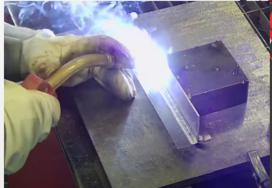
Сварка алюминиевого сплава АМг5 (тип 5356), толщина пластин 3.0 мм тавровое соединение, катет шва 3,0 мм Более высокая скорость сварки = меньшее тепловложение
