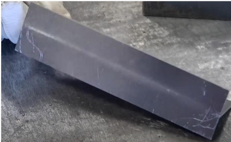
Обратная сторона полки – нижней пластины. Отсутствие перегрева и протекания основного металла.
