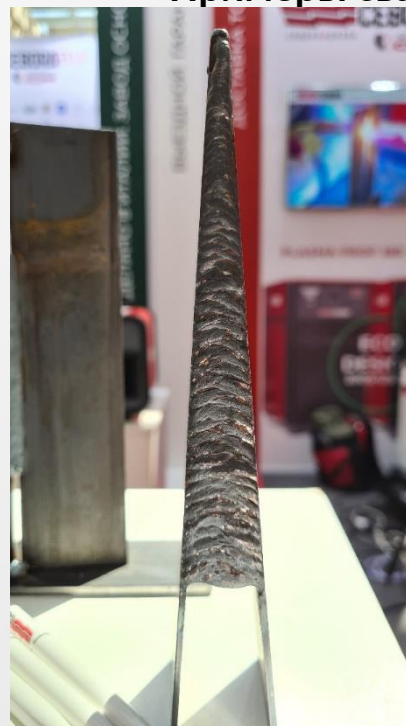
Проволока: Св-08Г2С-О, Ø1,0 мм Ток сварки: 54А Перекрытие зазора любой ширины Положение сварки: вертикальное
