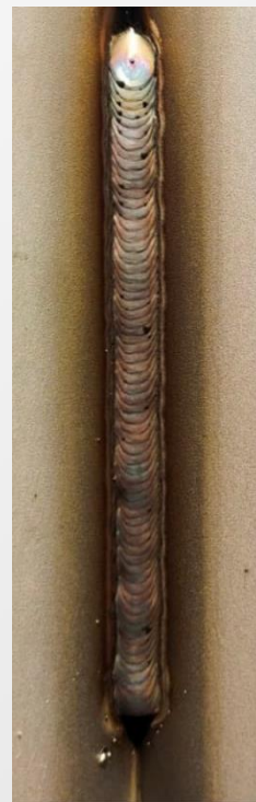
Проволока ER308LSi, Ø1,0 мм Средний ток 88А Скорость подачи проволоки 4,5 м/мин Среднее напряжение 18,4В
