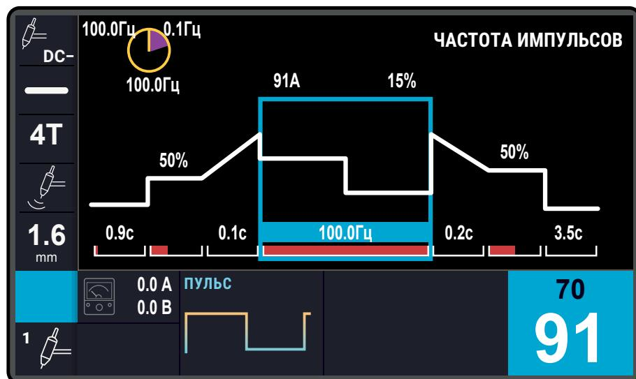
Рис. 23 – Вид циклограммы при активации параметра БАЛАНС
