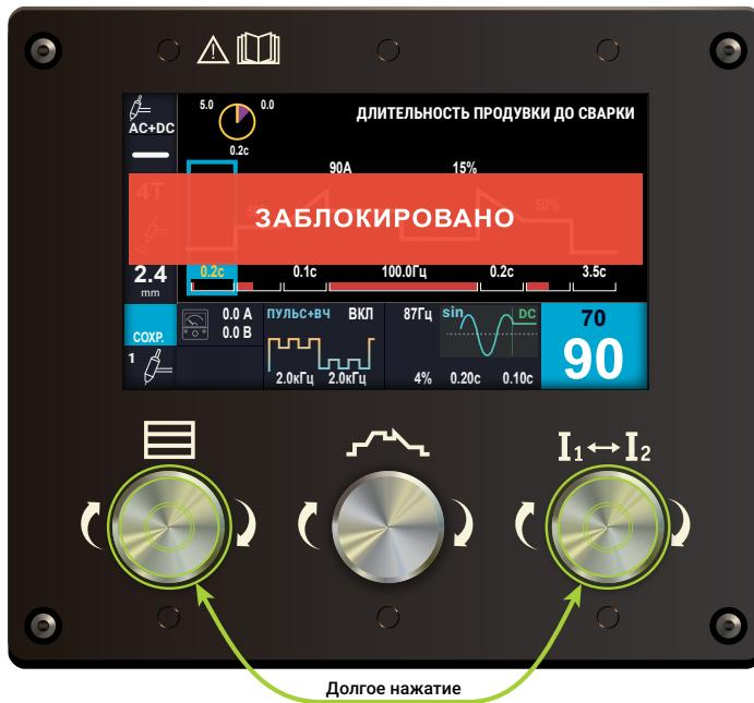
Рис. 13 – Принцип блокировки панели управления
