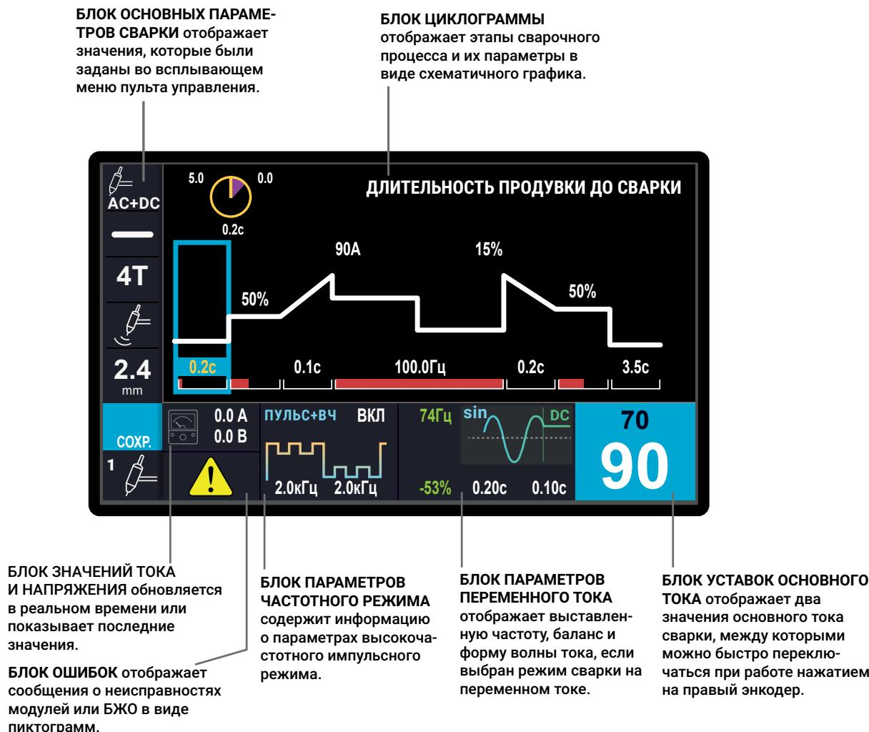
Рис. 15 – Блоки Главного экрана панели управления
