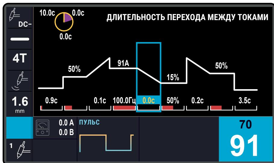
Рис. 22 – Вид циклограммы при активации параметра ВРЕМЯ
