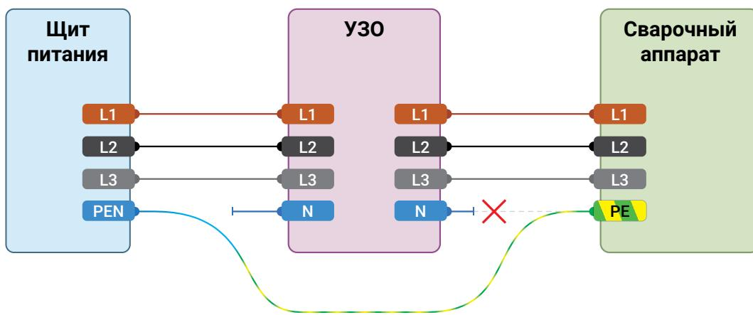
Рис. 8 – Схема подключения к системе TN-C с УЗО
