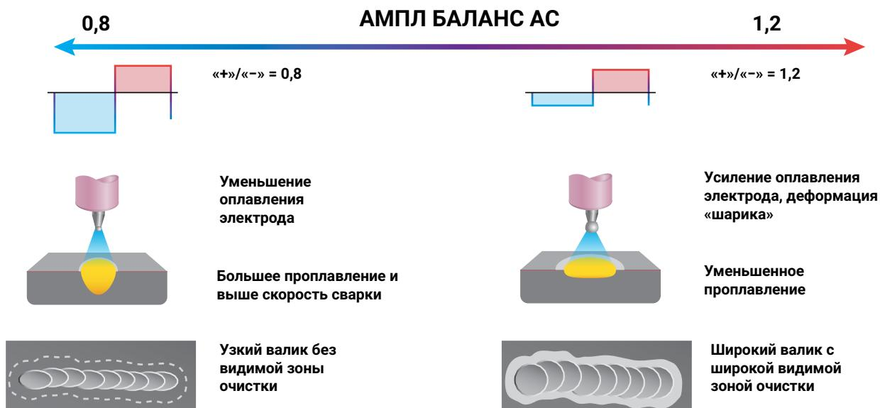
Рис. 37 – Качественное влияние параметра АМПЛ БАЛАНС АС на электрод, деталь и сварное соединение 67
