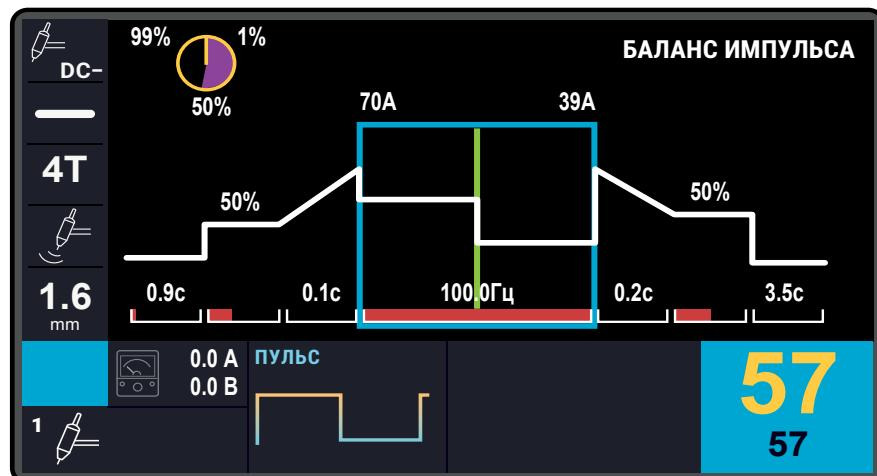
Рис. 25 – Вид циклограммы при активации параметра АВТОБАЛАНС
